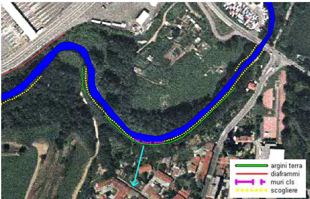
Fig. 8.10 Le opere di difesa spondale nel tratto a monte della discarica, con indicato il punto interessato dalle esondazioni storiche (freccia)
